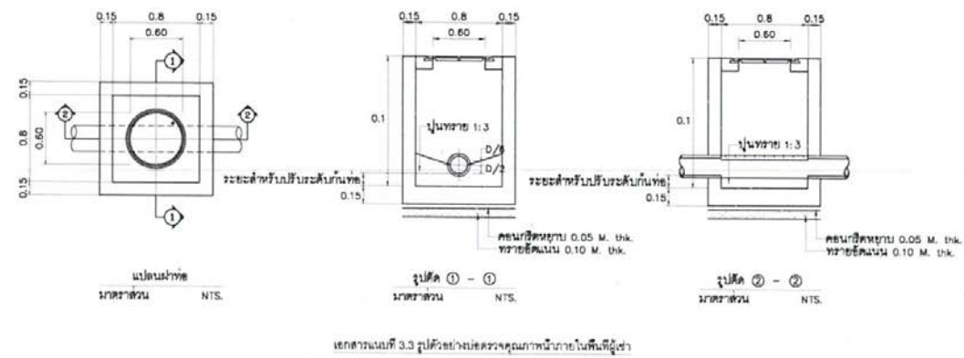
รูปที่ 6.8 รูปตัวอย่างบ่อตรวจคุณภาพน้ำภายในพื้นที่ผู้เช่า
